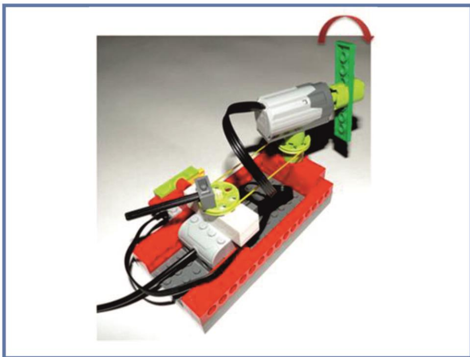
1. Двигатель вращает винт вентилятора, как показано красной стрелкой
